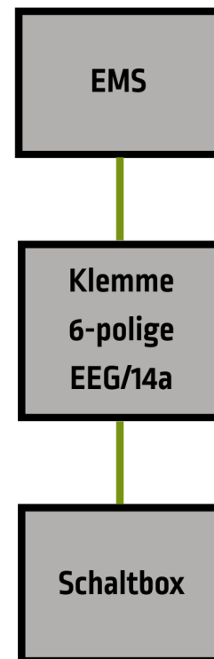
Abbildung 4: Aufbau Direktansteuerung und EMS
